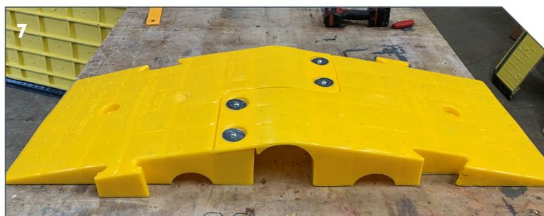
Verwenden Sie den Akkuschlagschrauber, wenn alle 4 Befestigungen handfest angebracht wurden. Fixieren Sie hierfür die Schraube mit dem T-Griff Innensechskantschlüssel, während Sie die Mutter mit dem Akkuschlagschrauber festziehen. Sie benötigen hierfür eine Steckschlüsselverlängerung.
