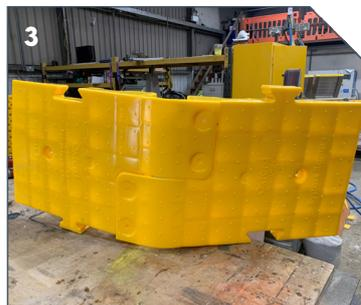
Stellen Sie zwei Bypass Rampenhälften seitlich auf und legen Sie diese so passgenau aufeinander, dass Sie sie zusammenstecken können. Die Vorderseite sieht dann so aus.
