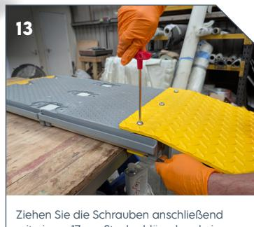
Ziehen Sie die Schrauben anschließend mit einem 17mm Steckschlüssel und einem 6mm Sechskantschlüssel per Hand fest.
