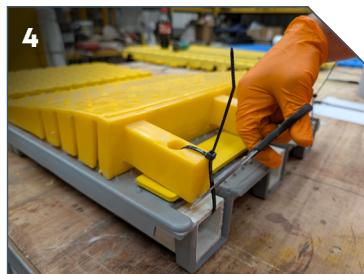
Schneiden Sie zunächst die Kabelbinder durch, an denen das gelbe, biegsame Kunststoffendstück befestigt ist.
