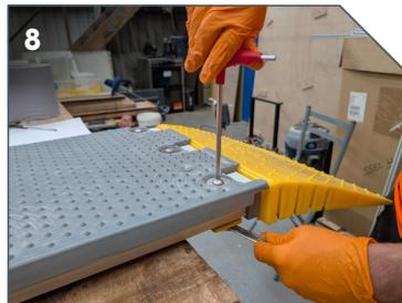
Ziehen Sie die Schrauben anschließend mit einem 17mm Steckschlüssel und einem 6mm Sechskantschlüssel per Hand fest.
