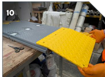
Legen sie das gelbe Stahlendstück so über das graue Mittelteil, dass die 3 Löcher jeweils übereinander liegen und stecken Sie 3 x M10 x 90 Senkkopfschrauben hinein.
